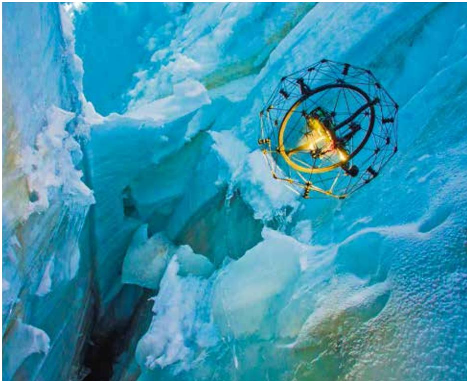
**LAUSANNE.** Eine ungewöhnliche Drohne erkundet hier eine Gletscherspalte oberhalb von Zermatt. Damit sie allfällige Kollisionen übersteht, sind Motor und Kamera von einem kugelförmigen Rahmen umhüllt. Dieser federt Zusammenstösse mit Hindernissen ab. So kann der robuste Flugroboter
